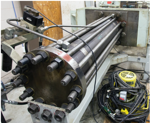
Long bed tensile test frame
